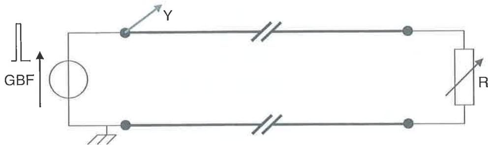
**Figure 8** – Dispositif de mesure sur une paire torsadée
