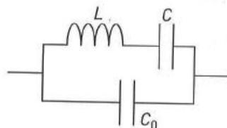
On donne :  $L = 66,266 \text{ mH}$  ;  $C = 35,6 \text{ pF}$  et  $C_0 = 8,9 \text{ pF}$ .
